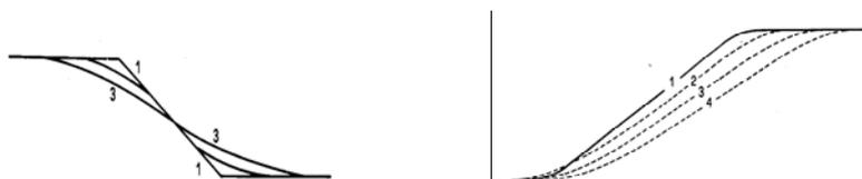
fig. 3.3.3 Evoluzione del profilo dei versanti per erosione diffusa e regolite: a) con deposizione al piede; b) con asportazione del cumulo.
